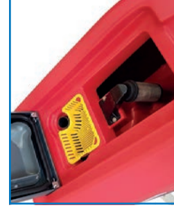
Réservoir d'eau sale avec filtre à grosses saletés
